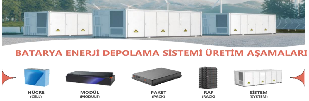
Görsel 1: Batarya Enerji Depolama Sistemi Üretim Aşamaları
