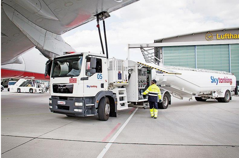
Görsel - 2: Tanker (Refueller) Kullanımı Yoluyla Jet Yakıt Tedariki
