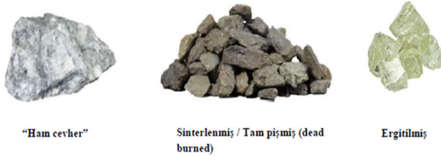
Görsel 2: Ham Cevheri Sinterlenmiş ve Ergitilmiş Ürünler
